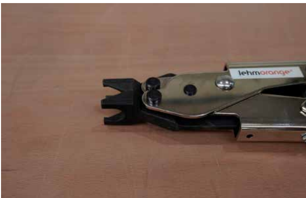
Verpresswerkzeug zusammengesetzt
