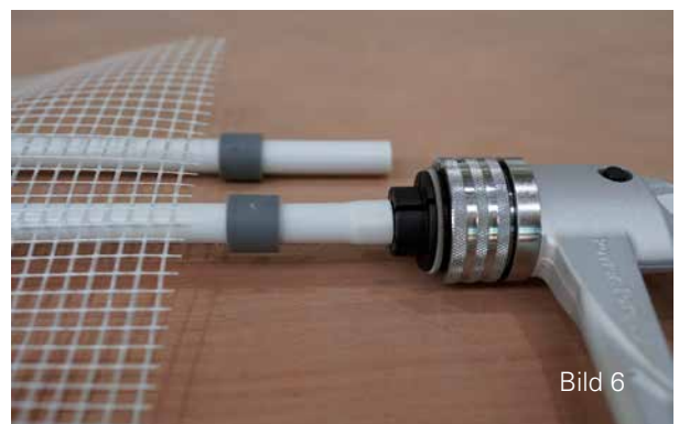
Rohrenden aufweiten
