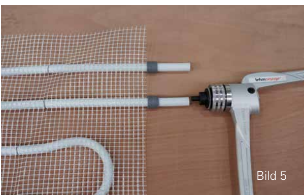
Aufweitdorn einführen
